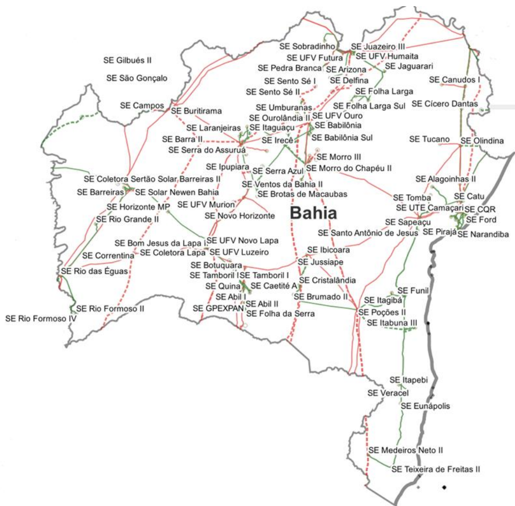
Figura 4-23 – Sistema de Transmissão do Estado da Bahia.
